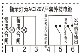
JDQ2-6□□(消防、发电型)端子接线原理
