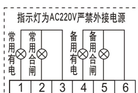
JDQ2-6□□(基本型)端子接线原理
